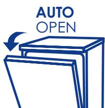
**Smart door** es la solución que permite que la puerta del lavavajillas se abra automáticamente al finalizar el ciclo. Esto ayuda a conseguir un secado más rápido y a **mejorar la eficiencia energética** maximizando el rendimiento del secado en clase **A+++ -10%**.
