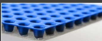
**DRAIN:** Sistema de dessolidarização, drenagem e ventilação de estruturas enterradas. **DRAIN** é uma lâmina nodular de polietileno com geotêxtil de polipropileno aplicado na parte inferior. Os nódulos têm uma altura de 10 mm.
